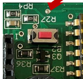
Рисунок 20: Расположение и увеличенный вид кнопки Reset на плате.
