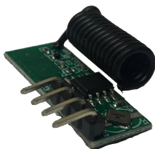
Рисунок 15: RF-приёмник, вход RF-приёмника и правильно установленное положение.
