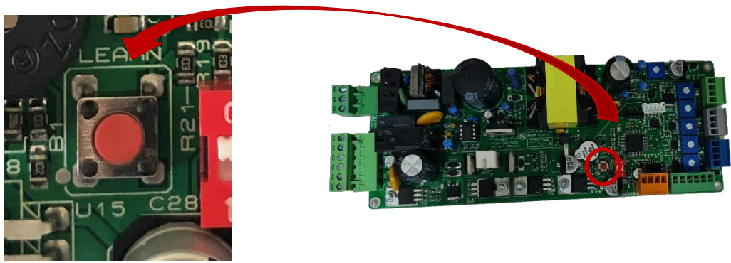
Şekil 8: LEARN butonunun kart üzerindeki konumu ve yakından görüntüsü.
