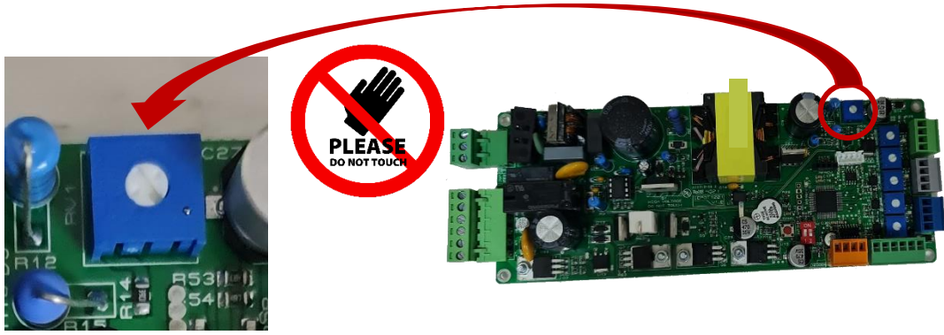
Şekil 9: Güç ayarlama potunun kart üzerindeki konumu ve yakından görüntüsü.
