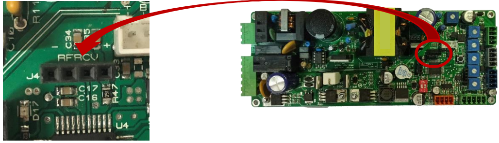
Şekil 3: RF alıcı soketin kart üzerindeki konumu ve yakından görünümü.
